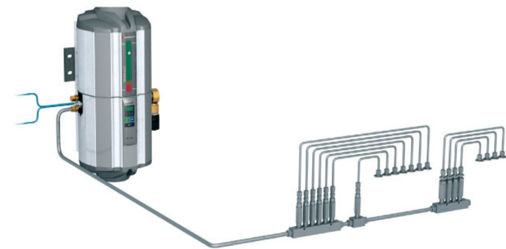
LG와 B - 단일 라인 중앙 집중 윤활 시스템 그라이스 윤활 NLGI 000 - NLGI 1 & 오일 LG와 B Doser 투입량 범위 0.02~0.50 Cm3
