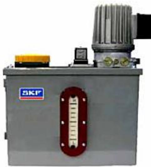
MFEユニットはシングルラインの集中潤滑システムにおいて間欠的に潤滑油を供給する為に使用するものです。標準の仕様はモーター付ギアポンプ、潤滑油用金属タンク（3, 6, 15, 30L）、潤滑油の下限を検知するフロートスイッチです。
